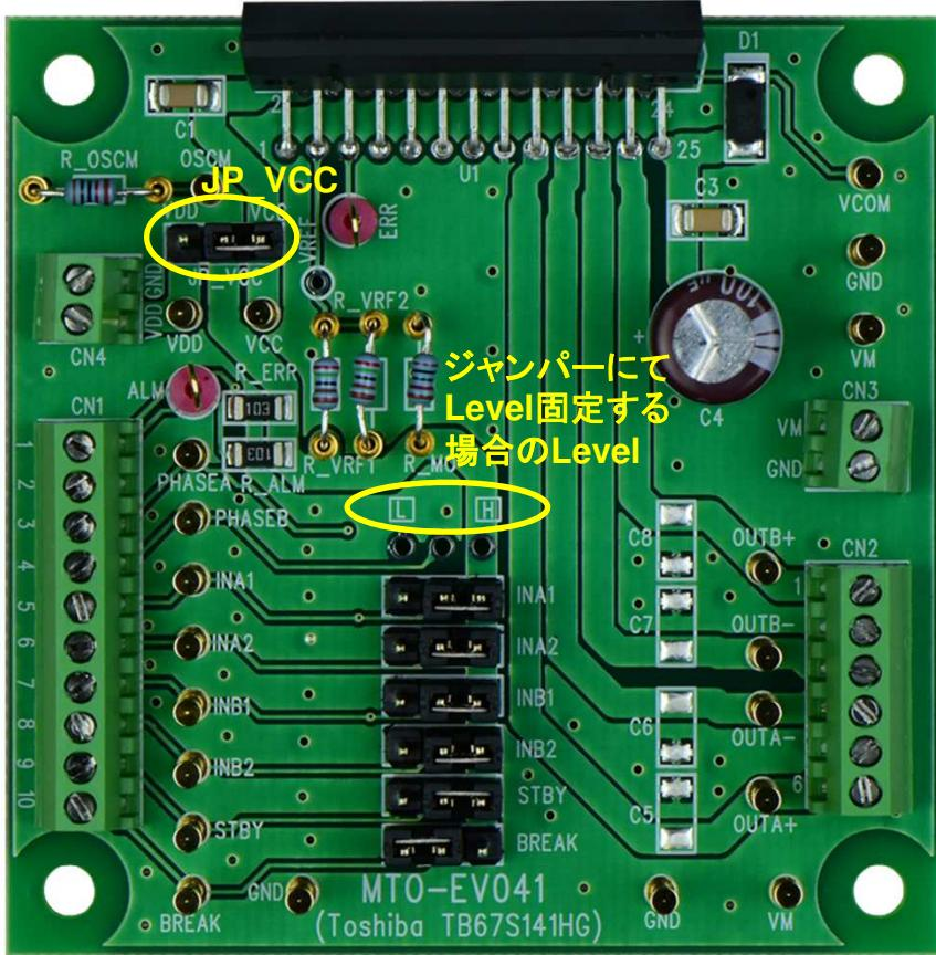
本評価基板には、TB67S141HGの動作設定を行うための、左図の様なジャンパーを設けております。ジャンパーにて機能を選択する場合は、JP\_VCCをVCC側とショートしてください。
