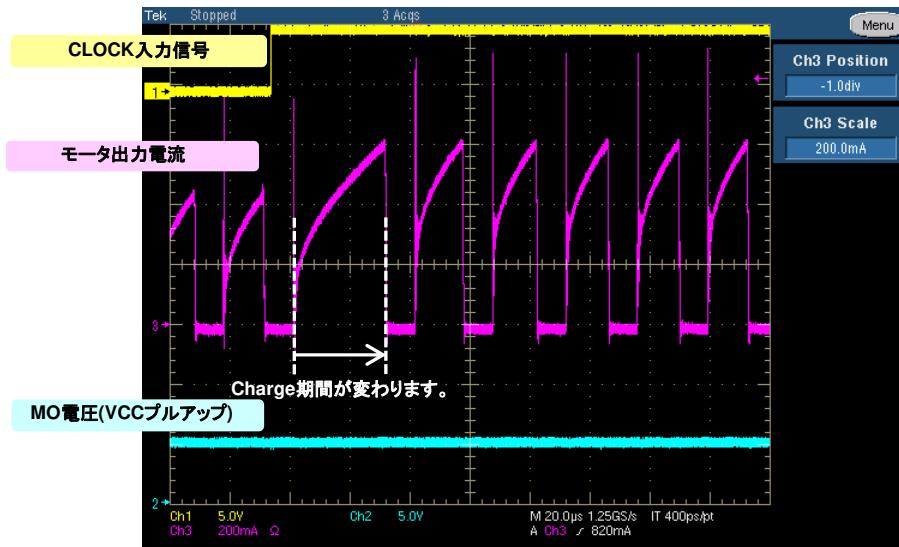
設定電流値(ステップ)が切り替わった場合、次の設定値にモータ電流が到達するまでの期間(Charge期間)は変わりますが、回生期間(固定オフ時間)は設定された値のまま継続します。
