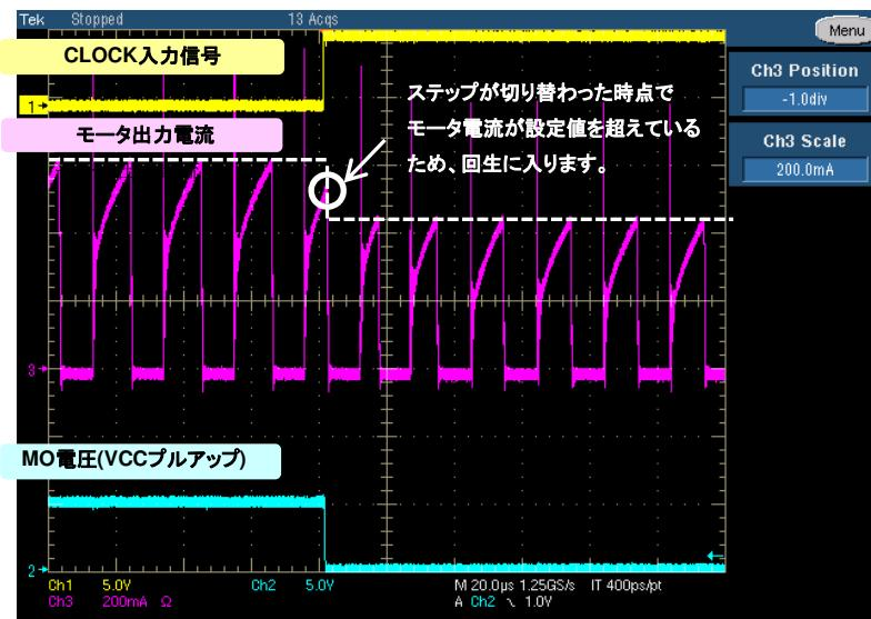
設定電流値(ステップ)が切り替わった場合、その時点でモータ電流が電流設定値を超えている場合は、回生に移行します。モータ電流が次の設定値に到達前、あるいは回生中にステップが切替わった場合、次の設定値に従い定電流PWM動作を行います。
