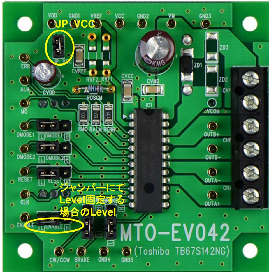
本評価基板には、TB67S142NGの動作設定を行うための、左図のようなジャンパーを設けております。ジャンパーにて機能を選択する場合は、JP\_VCCをVCC側とショートしてください。ジャンパーの上部にあるシルクが固定されるLevelを示しています。使用する機能設定に従い、ショートさせる位置を変更して下さい。また、外部から信号を入力される場合は、ショートピンを外してご使用ください。
