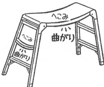
④各部の接合部に割れやいちじるしい腐食がありませんか。また、取り付け部品の破損・脱落・変形・磨耗・いちじるしい腐食がありませんか。ある場合は、**絶対に使わない**で廃棄してください。
