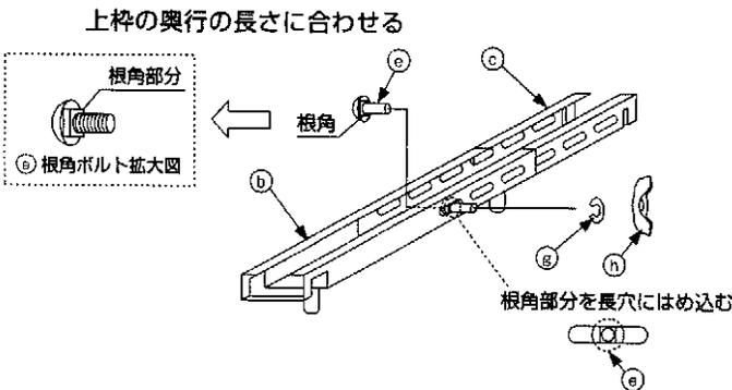
2. で仮組みした吊金具を作業台の上枠の中に入れ、前後にスライドさせ蝶ナット ⑧ を締め付けて下さい。(左右2本)
