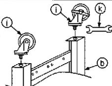
アジャスターⒸを取外しキャスター①②を脚Ⓑに取付け、スパナⒼでネジの根元までしっかりと締付けて下さい。(4ヶ所)
