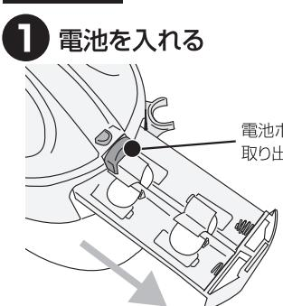
電池ボックス取り出しボタンを上に引き上げて(ブルアップ式)、電池ボックスを取り出し、単1乾電池を4個入れます。
