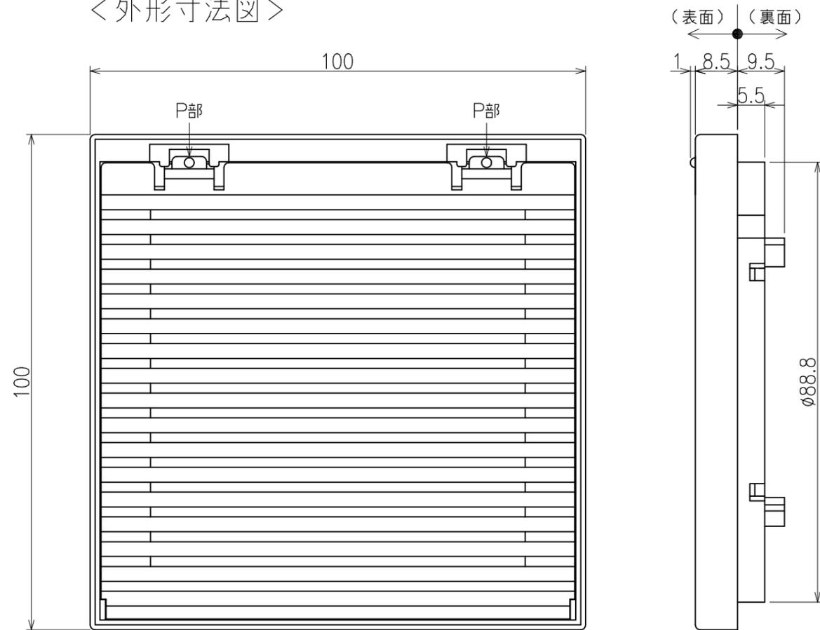
上図P部の押下によりルーバー部分が取り外し可能です。
