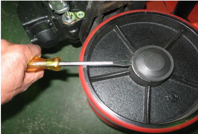
⑥車輪の樹脂キャップをマイナスドライバーを用い外す
