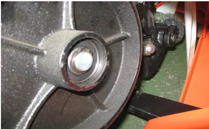
⑦軸用C型止め輪を外す * 止め輪をなくさないようご注意ください 車軸より古い車輪を抜き取る ベアリング挿入した新しい車輪を 取り付ける * 車輪の交換は片方ずつやる ⑦車輪に樹脂キャップをハンマーを用い 軽く叩いてはめる
