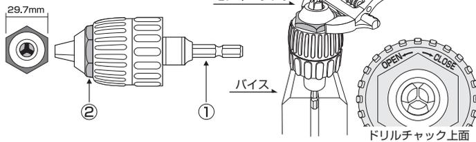
固く締め過ぎて先端工具が抜けられない場合は、六角シャンク①をバイスでしっかり固定し、解除用ナット②をモンキーレンチ等ではさみ、上図OPEN方向に回して解除します。
