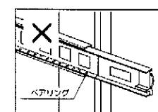
下段引出しへはめる際は、本体レールの内側のペアリング部分が、レールの一一番前にある伏筋で引出しひのレールにさし込んでください。（ペアリング部分が奥に入り込んだ状態ですと引出しが正しく入りません。）
