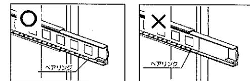
下段引出し奥はめる際は、本体レールの内側のペアリング部分が、レールの一番前にある状態で引出しのレールにさし込んでください。（ペアリング部分が裏に入り込んだ状態だと引出しが正しく入りません。）
