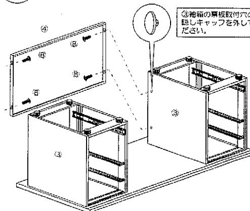
③袖箱の幕板取付穴の目隠しキャップを外してください。
