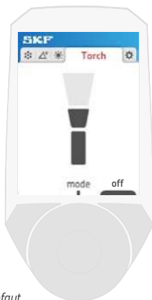
Fig. 19 – Pour utiliser le stroboscope en tant que torche
