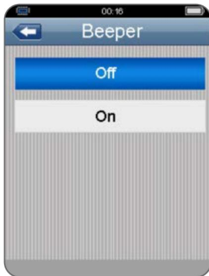
Drücken Sie die AUF- und ABWÄRTS-Taste, um den Signaltonstatus zu wählen. Drücken Sie zum Verlassen des Menüs und zum Speichern des gewählten Signaltonstatus die ESC-Taste.
