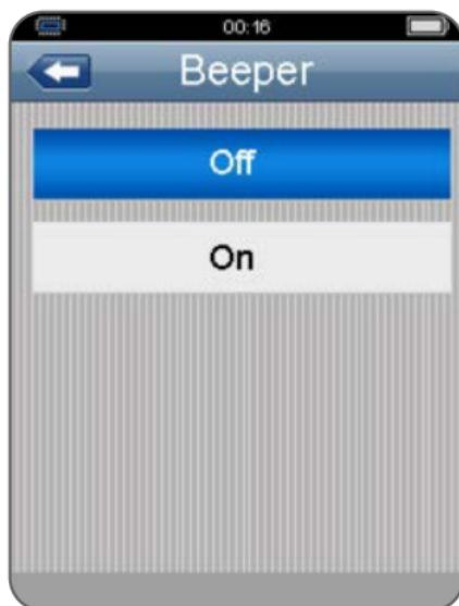
Appuyez sur les boutons Haut et Bas pour sélectionner l'état du bipeur et sur le bouton Esc pour sortir et enregistrer la sélection.
