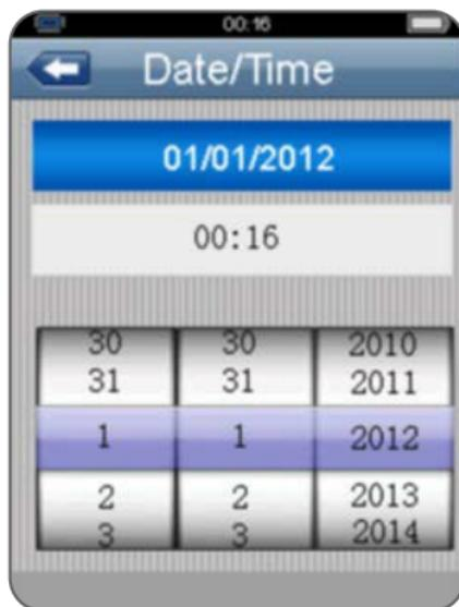
Pulse los botones ARRIBA y ABAJO para seleccionar la fecha o la hora. Luego pulse el botón ENTER para acceder al campo escogido; pulse los botones ARRIBA y ABAJO para ajustar el valor; pulse el botón ESC para salir y guardar.
