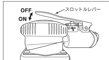
2. 作業前にエア取入口より、スピンドル油がタービンオイルを数滴入れて、軽く空回し運転を行い、可動部分に油をなじませて下さい。同様に作業後も注油して保管してください。
