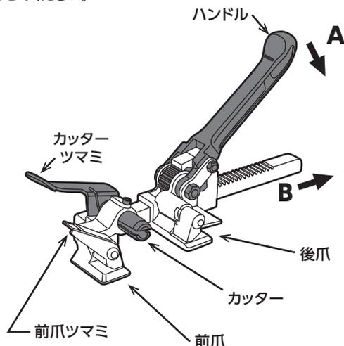
② 前爪ツマミをC方向に押し下げながら、前爪にPPバンドを通してください。梱包物にPPバンドを巻き、ハンドルをA方向に押ししながら後爪にPPバンドを通してください。そして、後爪に通したPPバンドをカッター部に通してください。
