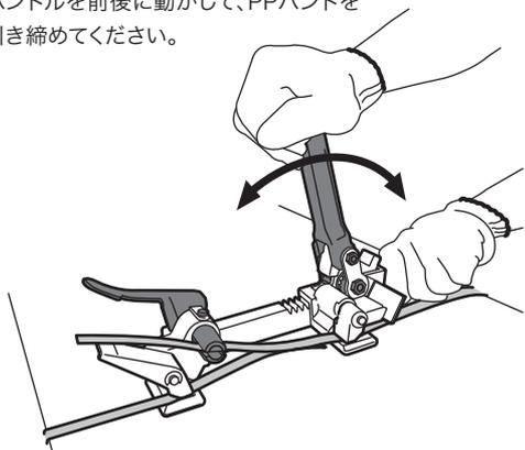
④ 引き締めが完了したら、カッターツマミをD方向に引いて、PPバンドの余り部分をカットしてください。カットできたら、前後爪を通っているそれぞれのPPバンドを束ねるようにシール(封かん)を通します。
