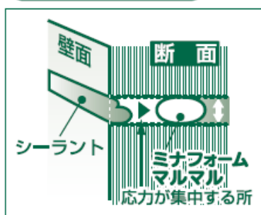
目地幅が狭くなった時
