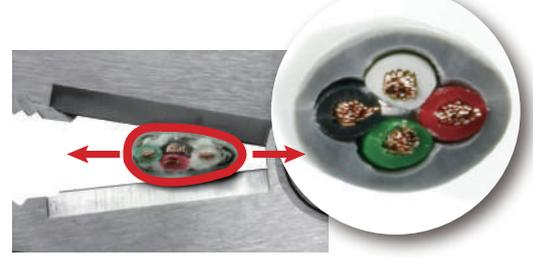
力が分散し、ケーブルが逃げるので切断しにくい。
