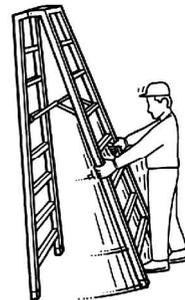
④ 開いた脚立は、開き止め金具で確実にロックしてください。
