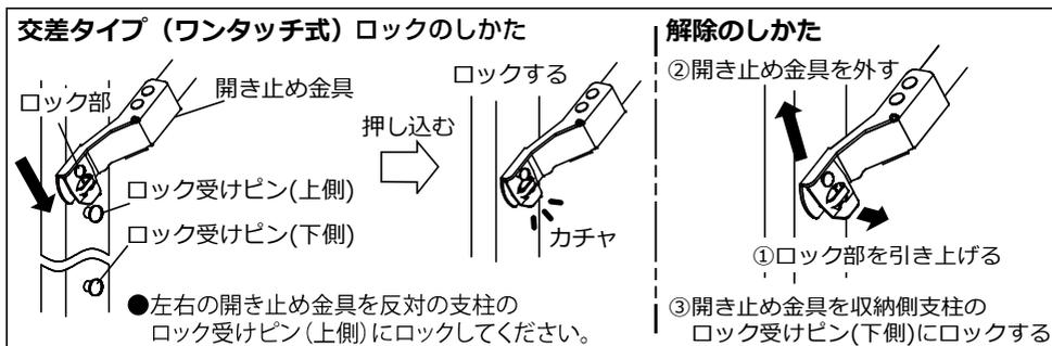
⑤ 脚立を折りたたむときは、開き止め金具のロックを解除したうえで①～③の逆の手順で行ってください。
