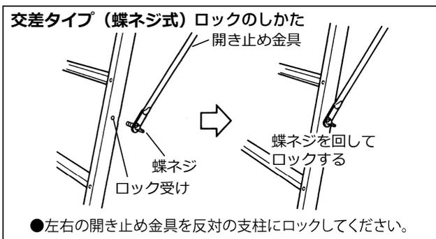
※解除するときは、開き止め金具の蝶ネジを回して、ロックを解除した後、開き止め金具を収納側支柱にロックしてください。
