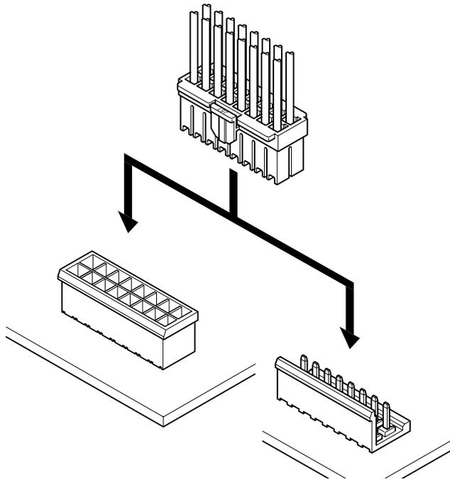
すでに家電製品・自動販売機・事務機などの電子、電気機器に数多く使用されているVHコネクタ及びSMコネクタの実績を生かして開発された、高信頼性の中継及びプリント基板用のコネクタです。
