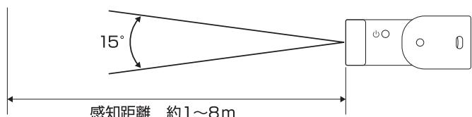
感知方向の調整 ※高さ1.5mに設置した場合
