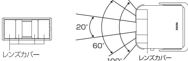
感知距離 約3m～約7m ※高さ1.5mに設置した場合／気温20°C時
