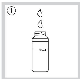
測定対象の検水を使用し、バイアル瓶を2回程洗った後、15mlまで検水を入れてください。
