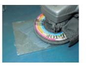
硬化後はサンダー等での研磨加工が可能です。 ※サンダー等での研磨加工は塗布後24時間以上たってから行って下さい。塗装は、指触乾燥後(塗布後約2.5時間後)から可能です。 ジンクパテST 主剤
