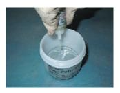
50gセットと100gセットを全量使用する際は、主 剤の容器に付属の硬化剤を全量投入します。 300gセット使用時や、小分けで使用する際は、主 剤と硬化剤を100:4.8 (重量比)で正確に計量して 配合します。
