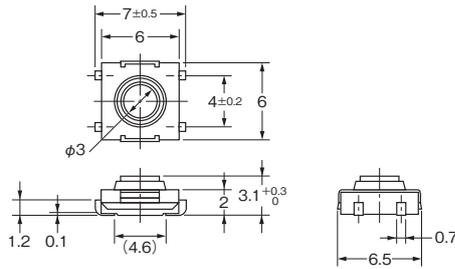
プリント基板パッド寸法例 (TOP VIEW)
