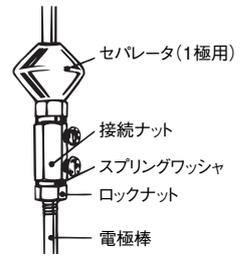
\* 電極棒、接続ナット、ロックナット、セパレータ個々の詳細は、形F03-□を参照ください。
