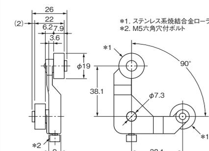
注. 上記、各種類の外形寸法図中、指定のない部分の寸法公差は±0.4mmです。
