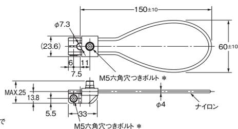
\* 適正締付トルクは4.90~5.88N・mで締付けてください。
