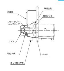
DBダイアル専用の取付金具と取付ナットを用いてポテンショメータをパネルに取付け、ポテンショメータのシャフトを左一杯に回しゼロの位置に設定しておきます。
