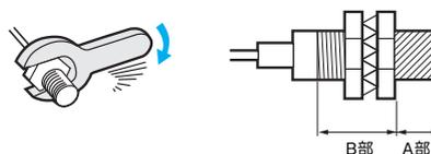
注1. ヘッド先端からの距離により許容強度が異なります。図のA部とB部での締めつけ許容強度を下表に示します。(A部とはヘッド先端から下表の寸法までの範囲です。B部は図のように、ヘッド側のナットも含まれます。したがって、このナット端が少しでもA部に入る場合は、A部の強度を適用してください。)
