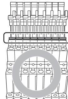
完全な挿入 全端子が奥まで挿入されている。
