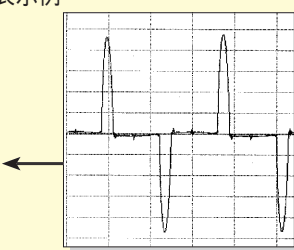
インバータ (一次側) の電流波形
