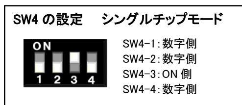
図 3-1 SW4 ジャンパ設定図1
