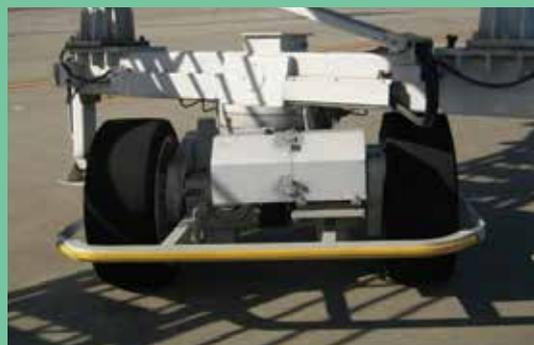
テープスイッチに専用外被を組み合わせ、検知対象物の保護機能を持たせています。
