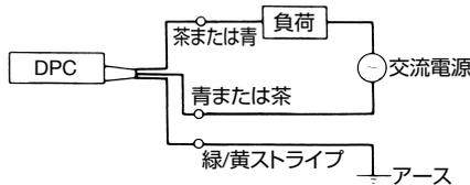
DPC形は安定動作を行うため、回路の一部がコンデンサを介してケース・アースになっています。このため必ず緑/黄ストライプの線を接地してください。なお、接地をせず使用すると、動作が不安定になる場合があります。(接地電流はAC100V時0.5mA以下、AC200V時1.0mA以下です。)
