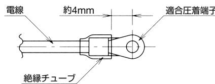
より線の場合、芯線のヒゲ線による隣接極の短絡にご注意ください。なお、ヒゲ線防止のためのはんだづけ処理は行わないでください。
