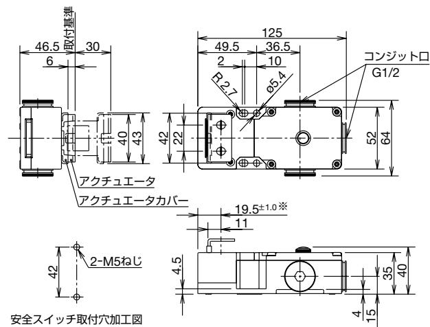
\*1) 2方向のアクチュエータ挿入口のうち、使用しない方の挿入口は、付属の角プラグでふさいでください。
