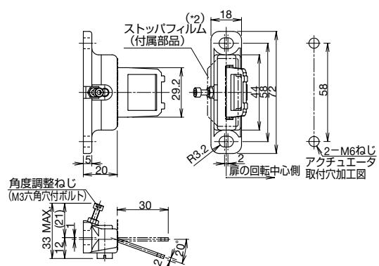
\*2) アクチュエータカバーおよびストップフィルムは、アクチュエータ位置決めのための部品であり、固定しな後は外してください。
