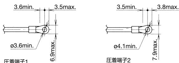
圧着端子をご使用の際は、必ず絶縁チューブを取り付けてください。
