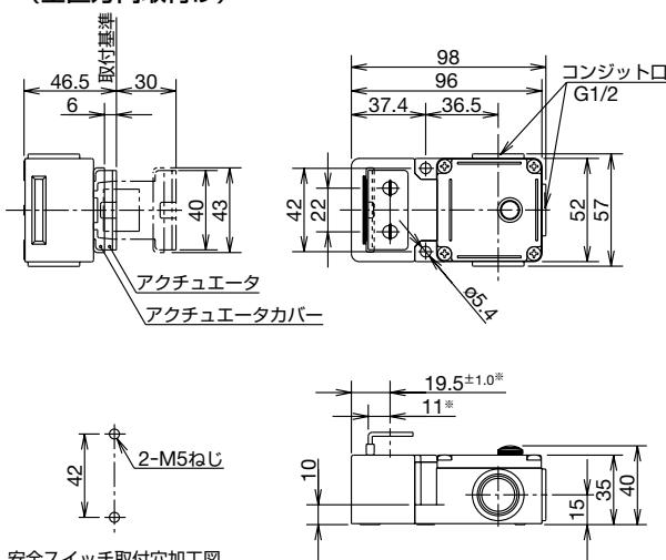
\*1) 2方向のアクチュエータ挿入口のうち、使用しない方の挿入口は、付属の角プラグでふさいでください。
