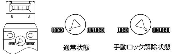
通常状態/手動ロック解除状態の切替操作は、付属の手動ロック解除Keyにて上図のように90完全に回して操作ください。途中で止めたまま使用しますと、誤動作や故障の原因となります。(手動ロック解除状態では、扉を閉じてもロックがかからず、メイン回路・ロックモニタ回路も開状態が保持されます。)
