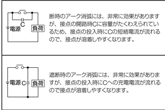
通常、直流誘導負荷は、抵抗負荷に比べ開閉が困難とされていますが、適切なアーク・キラーを用いると抵抗負荷と同程度まで性能が向上します。
