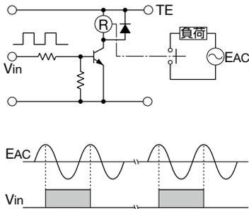
リレー接点を電源電圧に同期して開閉する場合、寿命が低下することがあります。このような場合、回路に要求される信頼性とのバランスでリレーを選択してください。または、開閉時の位相がランダムになるかゼロ位相付近で開閉するようにしてください。
