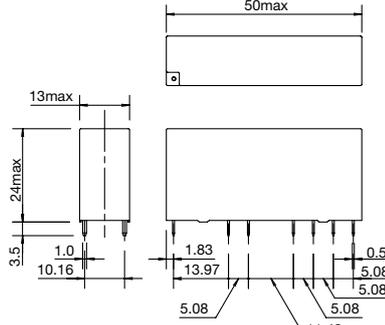
□ プリント基板用加工図 (BOTTOM VIEW)
