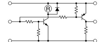
リレーの動作と同時に別信号を取り出す場合、回路上注意が必要です。例えば、悪い例では暗電流I0が流れます。暗電流がリレーコイルに流れると復帰不良や、耐振動、耐衝撃の低下をまねくことがあります。改善例のような回路にしてください。
