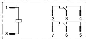
例) 端子3-4をa接点、端子6-7をb接点として使用する。
