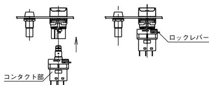
4.上記1で作ったプリント基板を上記3の操作パネルにセットします。
