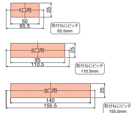
※石膏ボードなど、ねじの効かない場所への取り付けはおやめください。取付面が破損したり、器具が脱落するおそれがあります。
