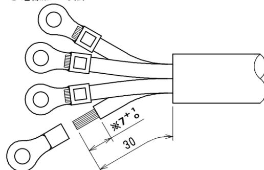
※被覆剥き寸法の7<sup>+0</sup>/<sub>-1</sub>は3.5mm<sup>2</sup>のものであり、5.5mm<sup>2</sup>は8<sup>+0</sup>/<sub>-1</sub>とする。
