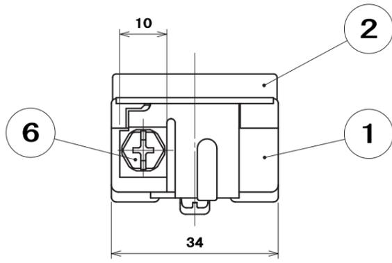
適用電線：銅単線 φ 1.6mm、φ 2mm
