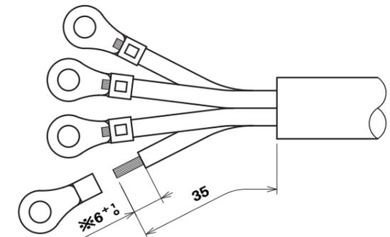
※被覆剥き寸法の6<sup>+1</sup>は1.25mm<sup>2</sup>及び2mm<sup>2</sup>のもので、3.5mm<sup>2</sup>は7<sup>+1</sup>
