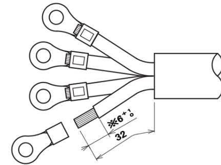
※被覆剥き寸法の6<sup>+</sup>は1.25mm<sup>2</sup>、2mm<sup>2</sup>のもので、3.5mm<sup>2</sup>は7<sup>+</sup>
