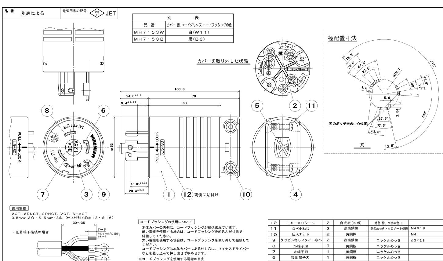
※コードブッシングを使用する電線の目安電線の外径が約13~約14.5mm(3.5mm²3心)の場合はコードブッシングを使用してください。
