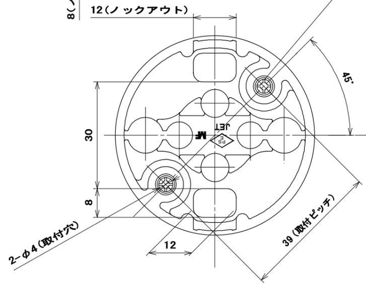
適用電線：VVVF 2心  $\phi 1.6$ ,  $\phi 2$
