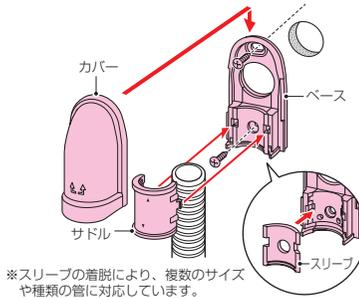
※スリーブの着脱により、複数のサイズや種類の管に対応しています。
