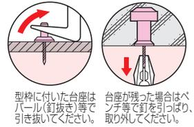
**施工要領** (※幕板への打ち付けは、真直ぐ最後までシッカリ打ち付けてください。)
