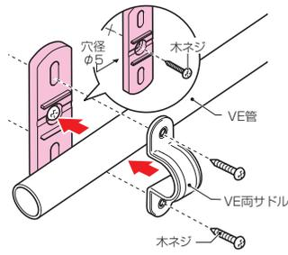
VE両サドル台座を木ネジで固定し、両サドルでVE管を台座に固定します。
