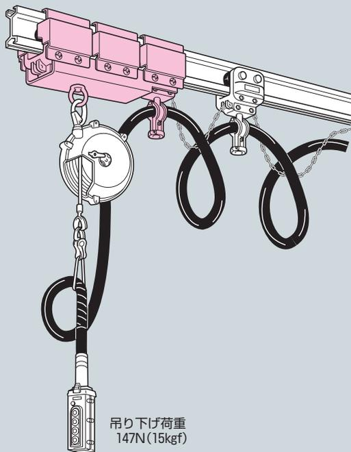
●ケーブル以外の中量物の吊り下げに使用します。
