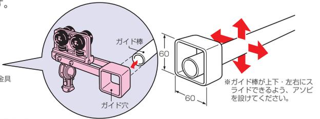
●先頭カッシャーに設けてある牽引用ガイド穴に鉄パイプ、アーム等のガイド棒を通し、カッシャーを直接誘導してください。
