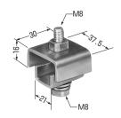
推奨トルク:5.88Nm (締め付け前に緩み止め )剤を塗布してください。)
