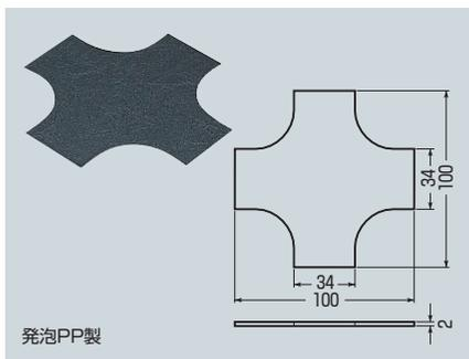
●弱電、強電が交差する場合の接触防止に使用します。
