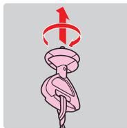
①バインドハンガーを断熱材に押しながらねじ込み固定します。
