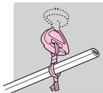
②ねじ込み固定後、バインド線でケーブルを固定します。
