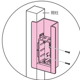
ボックス側面のねじ溝より間柱等にねじ止め固定してください。
